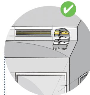
Lüftungsöffnungen in Rohrverkleidungen verhindern Dauerfeuchtigkeit
