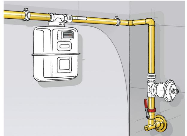
Der Erdgas-Hausanschluss: Hier liegt die Schnittstelle zur Gasübergabe „für den Hausgebrauch“ – und zugleich die Schnittstelle der Zuständigkeit. Denn: Ab der Haupt-Absperreinrichtung des Hausanschlusses liegt die Verantwortung für die Gas-Installation in den Händen von Eigentümern und Mietern.
